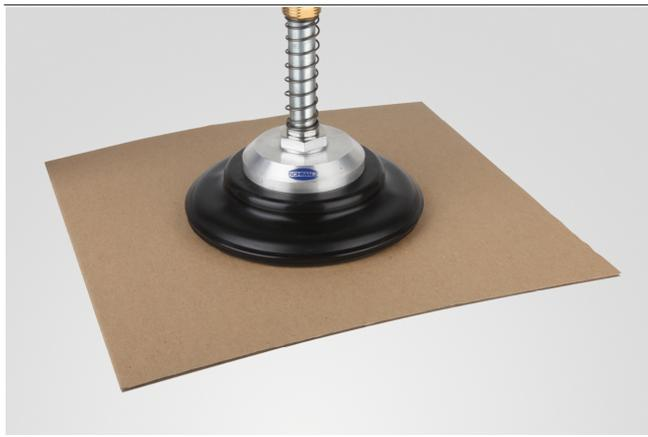
Balgsauggreifer FSGA bei der Handhabung von gepressten Holzplatten
